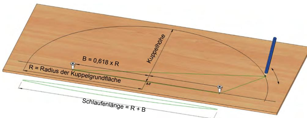
Nach der sogenannten Gärtnermethode kann die elliptische Schablone mit Hilfe einer Schnur und unter Beachtung des goldenen Schnittes ( $B = 0,618 \times R$ ) konstruiert werden.
