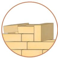
Hinteren Riegel leicht schräg festmörteln, damit obere Kante die gleiche Höhe wie hochkant gestellter Riegel hat und die Kuppelsteine besser angepasst werden können.
