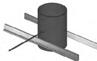
z. B. Winkeleisen an das Anschlussrohr schweißen
