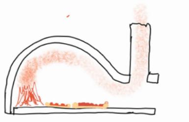
Belasten Sie den Backofen nicht mit dem Gewicht des Schornsteines. Nutzen Sie z. B. eine Trägerkonstruktion über die gesamte Backofenbreite, um das Gewicht abzufangen.
