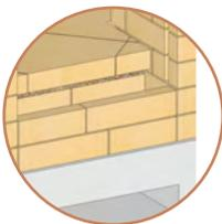
Riegel als Blende unterhalb der Tür zurecht schneiden und vermörteln.
