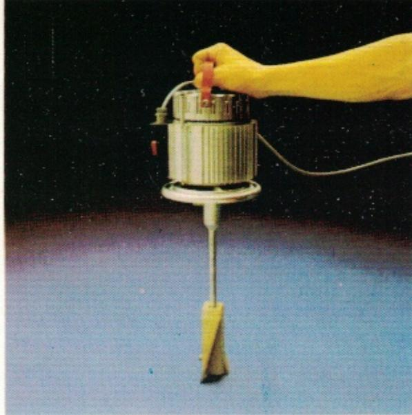
Le zangole di tipo verticale 10L - 15L - 20L sono state progettate e realizzate per ottenere il burro direttamente dalla panna sfruttando l'effetto della centrifugazione.
